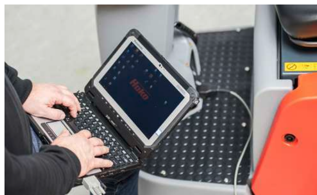
Eenvoudige toegang tot de diagnose-interface voor onderhoudsdoeleinden en het wijzigen van de rij-instellingen.
