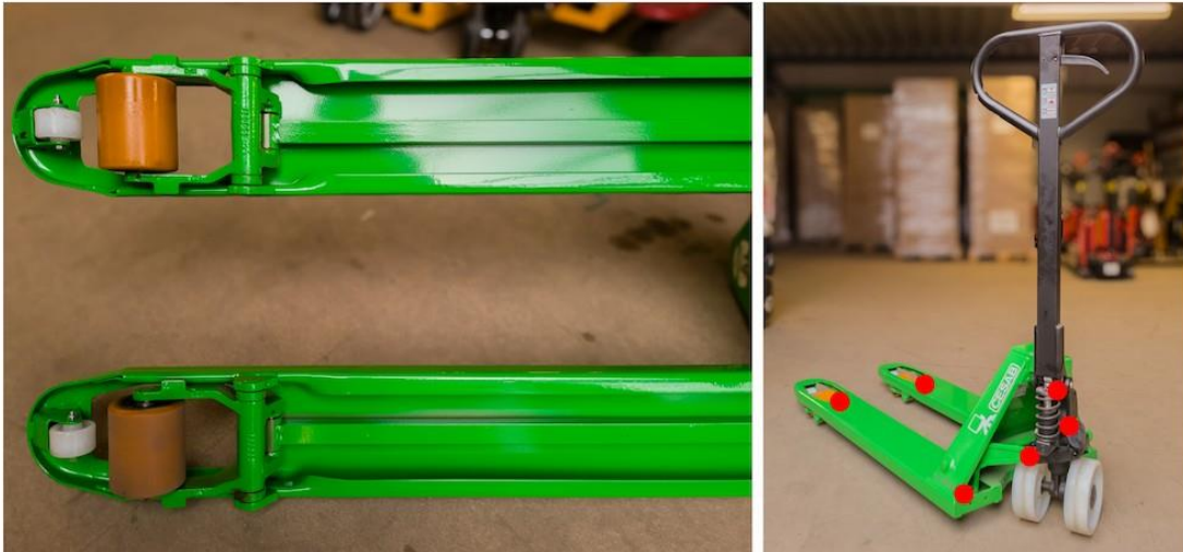
Onderzijde handpallettruck (links) | Verduidelijking smeerpunten handpallettruck (rechts)
