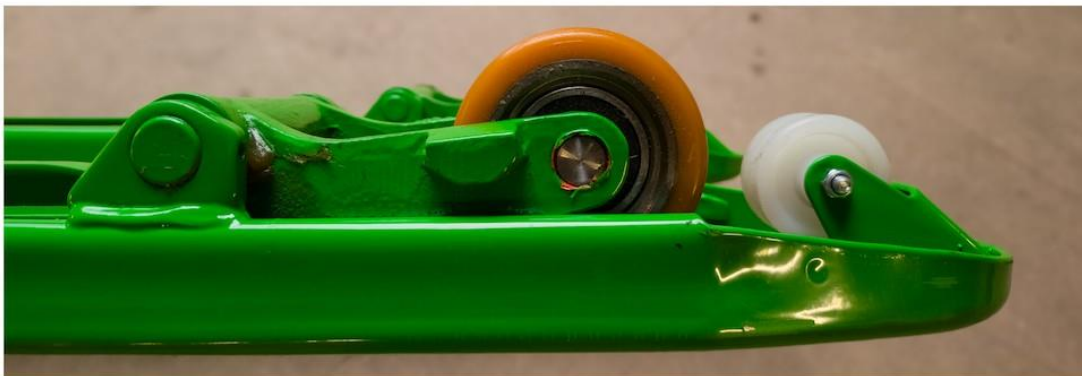
Onderzijde handpallettruck (links) | Verduidelijking smeerpunten handpallettruck (rechts)
